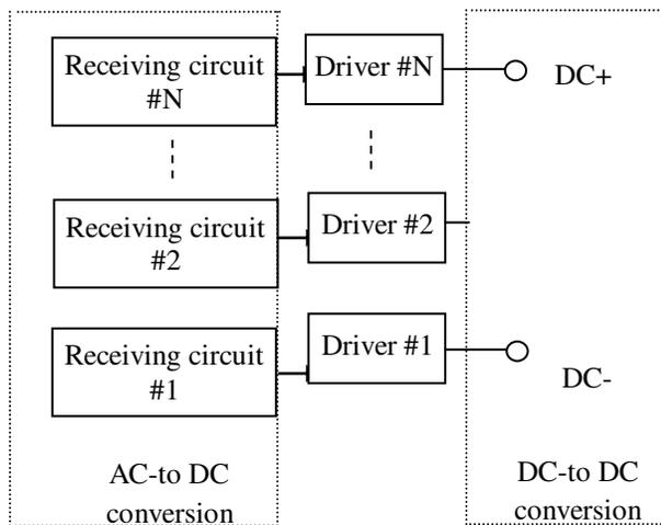
**Fig. 1: WPT SYSTEM PROVIDING POWER TO THE DRIVER CIRCUITS IN A MULTILEVEL CONVERTER**
